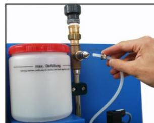
Beim ersten Auffüllen des Duftstoff-Behälters gelang automatisch Luft in den Pumpenkopf. Um eine sichere Funktion der Pumpe zu gewährleisten, muss diese entlüftet werden. Dazu muss der Pumpenschlauch vom Dosierventil abgezogen werden (s. Bild). Bei jedem weiteren Nachfüllen von Duftstoff muss die Pumpe nicht mehr entlüftet werden!
